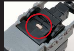
04 動力ユニット裏の電源スイッチ(白い四角)を押します
