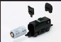
01 動力ユニットにCR2型リチウム電池を入れ、動力端子にウェイトを取付けます
