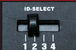
05 ID-セレクトスイッチを、ポイントと同じく「2」に設定します
