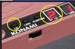
01 電動ポイントレールの電源をONにし、IDを設定します(例では「2」を指定)
