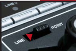
04 コントローラーのLINE/POINT切替スイッチを「POINT」に切り替えます
