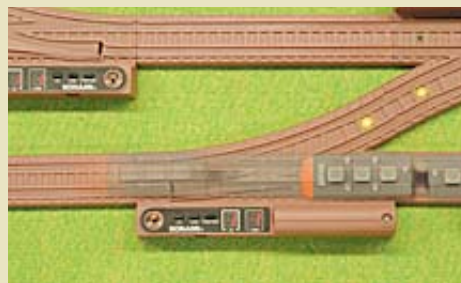
▲分岐側の非開通方向(写真では直線側)からの列車進入もOK。スプリングポイントとして機能する。
