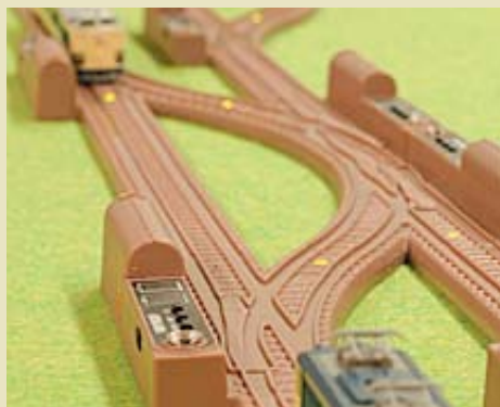
▲遠方のポイントの開通方向も、LED表示によって一目でわかる。
